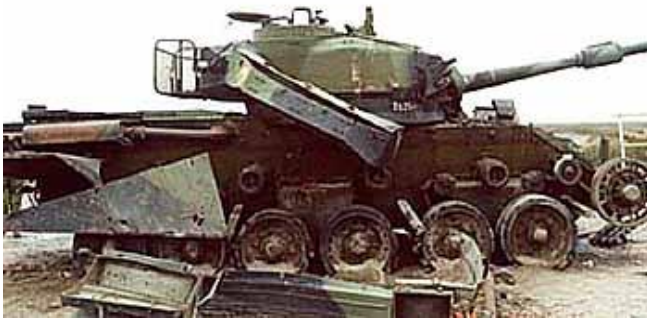
ტანკი „ცენტურიონი“ 155 მმ-იანი საარტილერიო ჭურვის ნამსხვრევების ზემოქმედების შემდეგ (ჰაერში ახლო (10 მ) აფეთქება)
