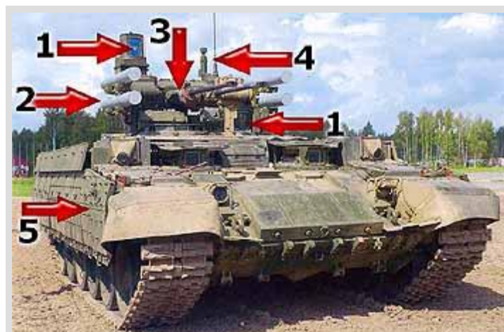
Рис. 6. Уязвимые для осколков 155-мм снарядов элементы БМПТ: 1 – головные части и входные окна прицелов; 2 – контейнеры ПТУР; 3 – приводы наведения; 4 – датчики СУО; 5 – элементы ДЗ
