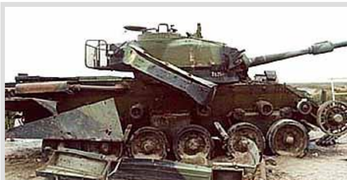
Рис. 3. Танк «Центурион» поврежденный близкими разрывами 155-мм ОФС
