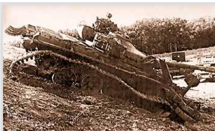
Рис. 4. Танк, поврежденный близким разрывом 155-мм ОФС с ударным взрывателем
