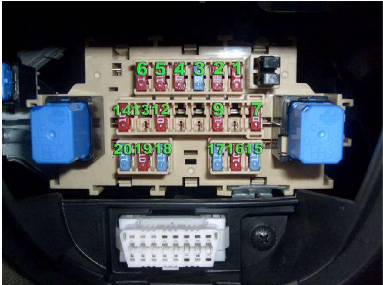
**1 (10A)** Аудио система, привод зеркал Audio-Асс, питание моторов поворотных зеркал, питание NATS(с чип-ключом)
